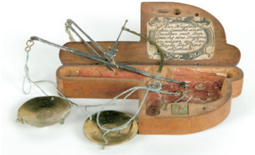
Nürnberg. Münzwaage von Paulus Deinert (Meister seit 1747, † 1783) zum Wiegen eines Dukaten sowie einer Dublone. Eine Waagschale wiegt genau einen Dukaten (3,5 g) mehr als die andere. Eine Dublone oder Pistole wog 3,23 g mehr als ein Dukat, diese Differenz wird durch das kleine Zusatzgewicht ausgeglichen. Abweichungen konnten an der bogenförmigen Skala abgelesen werden. Die Nürnberger Dukatenwaage – sonst ohne das Zusatzgewicht – ist wohl die einzige technische Innovation im Bereich der Münzwaagen des 18. Jh. Lade: 13,2 cm.
