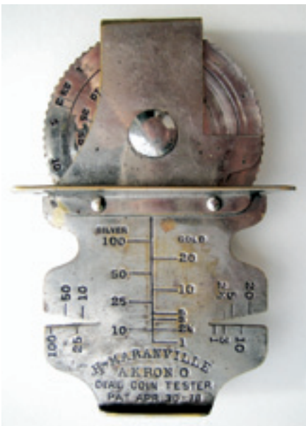
USA, Maranvilles' rotating dial steelyard. Münzprüfer mit drehbarer Scheibe, an der das Gegengewicht angebracht ist. In den Kerben kann die Dicke geprüft werden. Vermickeltes Messing, patentiert 1878. 9 x 6,4 cm.
