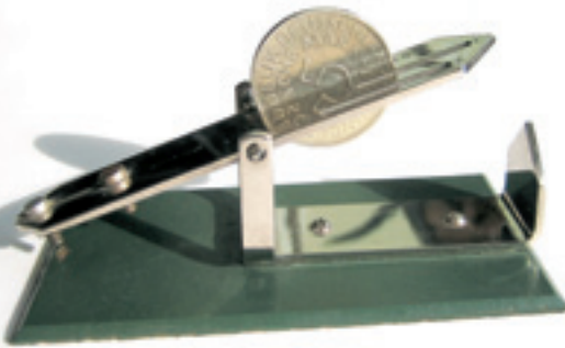
Deutschland, Münzprüfer für 1-, 2- und 5-DM-Münzen nach 1951, nach dem Prinzip des Sovereign Rockers. Bei der hier aufgelegten 5-DM-Münze handelt es sich um eine Fälschung in Neusilber; sie wurde zu leicht befunden ... Verchromtes Messing auf Hartfaserplatte, 10 x 5,5 cm.
