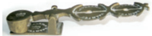
England, Sovereign Rocker , Messing, 19. Jh. Im Grunde ein ideales Prüfgerät, mit ihm konnte nicht nur das Gewicht, sondern auch die Größe und durch den Schlitz die Dicke der Goldmünzen geprüft werden. Länge ca. 10 cm.
