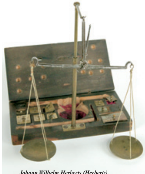
Johann Wilhelm Herberts (Herbertz), Solinger Münzwaagenbauer, siedelte ca. 1760 nach London um und baute dort Münzwaagen nach bergischem Vorbild, die er hübsch verzierte. Mit Gewichten in Guineas und Shillings. 16,5 x 8,3 cm.
