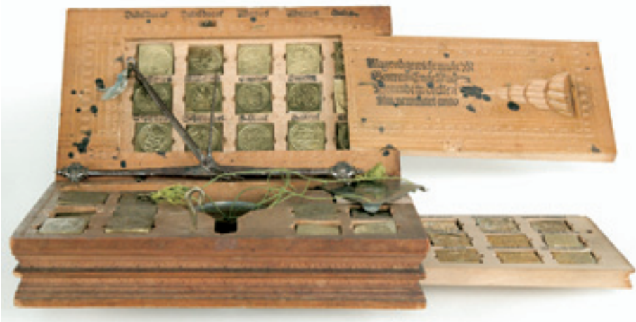
Kleine Waage des Meisters Bertram Engelskirchen, wohnende in Cöllen Am newmart (Neumarkt) anno (Jahreszahl nicht geschrieben). Mit 40 Gewichten, davon 15 unter einem Schieber im Deckel und 15 in einer Schublade unter der Waage. Da bisher keine andere Waage dieses Meisters bekannt ist, kann sie nur durch Stilvergleich um 1620 datiert werden. 14,7 x 8,7 cm.
